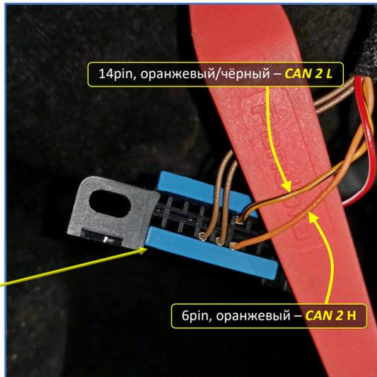
Рис. 6.1 и 6.2. Чёрный разъём OBD диагностики
