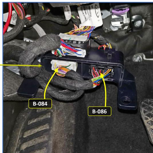
Рис. 1.3 и 1.4. Места подключений (блоком BCM слева на моторном щите)
