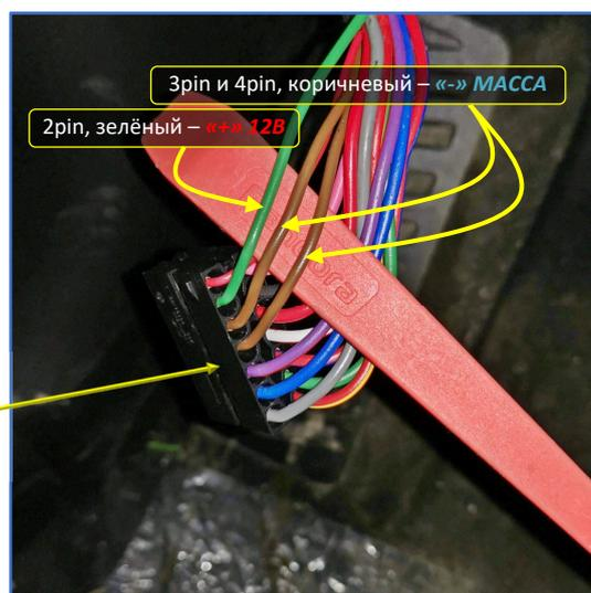
Рис. 5.1 и 5.2. Чёрный разъём В-078 ВСМ
