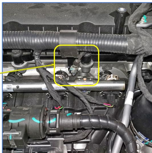
Рис. 10.1 и 10.2. Возможное место размещения датчика температуры двигателя
