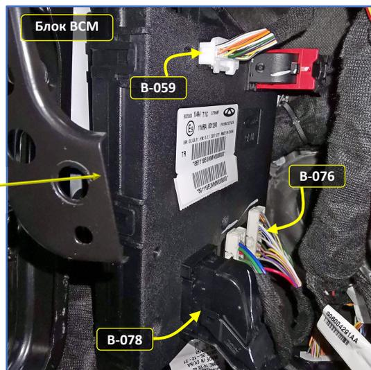
Рис. 1.1 и 1.2. Места подключений (слева от рулевой колонки)
