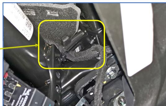
Возможное место расположения блока – за приборной панелью.
