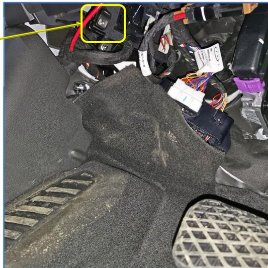
Рис. 9.1 и 9.2. Возможное место размещения кнопки «VALET»
