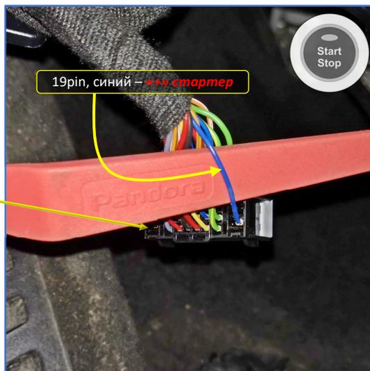
Рис. 8.1 и 8.2. Чёрный разъём В-086 под блоком ВСМ слева на моторном щите
