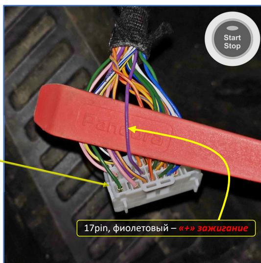
Рис. 7.1 и 7.2. Белый разъём В-084 под блоком ВСМ слева на моторном щите
